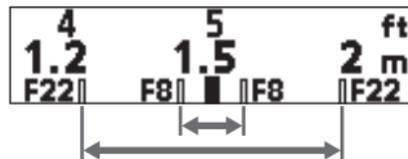
Глубина резкости - это расстояние спереди и сзади плоскости фокуса на объекте, которое отображается резким. Глубина резкости обозначается зоной между линиями шкалы глубины резкости под шкалой расстояний. Цифры на шкале представляют собой значения F.
