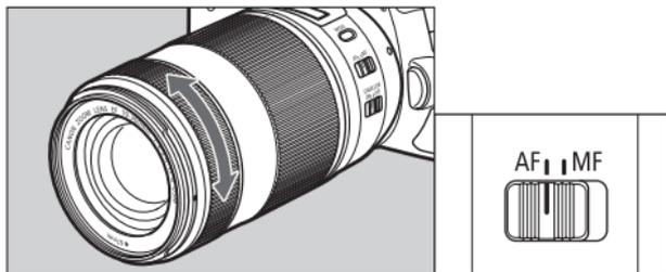
После выполнения автофокусировки в режиме AF или работы AF в режиме ONE SHOT AF, сфокусируйте вручную, нажимая кнопку спуска затвора наполовину и поворачивая кольцо фокусировки (полная ручная фокусировка).
