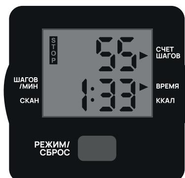
Стрелка на экране указывает на отображаемый в данный момент параметр.
