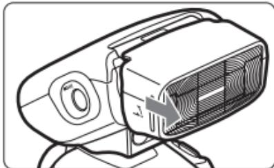
Die Leitzahl ist 27 (ISO 100, in Metern). Der Leuchtwinkel entspricht einem EF 50 mm-Objektiv (EF-S 32 mm) oder Objektiven mit größerer Brennweite.
