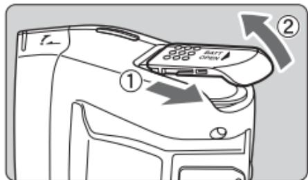
**1 Сдвиньте крышку отсека элементов питания и откройте ее, как показано стрелками.**
