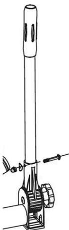
5. Вставьте поручень в посадочное место и закрепите с помощью болта, шайбы и гайки.
