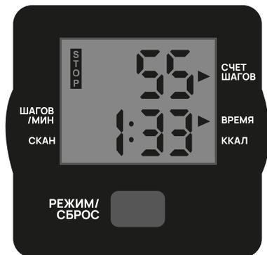
Стрелка на экране указывает на отображаемый в данный момент параметр. Нажатие на кнопку «РЕЖИМ/СБРОС» позволяет переключаться между тремя указанными выше показателями. Чтобы включить режим попеременного отображения этих показателей — установите стрелку напротив значка «СКАН». Удерживайте кнопку «РЕЖИМ/СБРОС» для обнуления значений тренировки. Через 4 минуты после окончания тренировки дисплей автоматически ВЫКЛЮЧИТСЯ.
