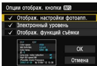
Во вкладке [F3] пункт [Опции отображ. кнопки INFO] позволяет выбрать параметр, который должен отображаться при нажатии кнопки <INFO.>.
