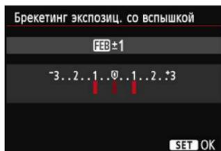
Мощность вспышки автоматически изменяется при выполнении трех последовательных кадров. См. подробнее в инструкции по эксплуатации вспышки Speedlite, совместимой с функцией брекетинга экспозиции вспышки.
