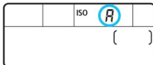
Если для чувствительности ISO задано значение «**A**» (Авто), фактически устанавливаемое значение чувствительности ISO отображается при нажатии кнопки спуска затвора наполовину. Как указано ниже, чувствительность ISO автоматически устанавливается в соответствии с режимом съемки.
