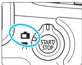
Во время съемки можно просматривать изображение на ЖК-дисплее камеры. Такой способ называется «Съемка в режиме ЖКД-видеоискателя». Съемка в режиме ЖКД-видеоискателя включается при установке переключателя съемки в режиме
