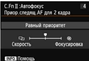
Вы можете настроить характеристики работы автофокусировки и синхронизацию срабатывания затвора после первого кадра при непрерывной съемке с помощью следящей автофокусировки AI Servo AF.
