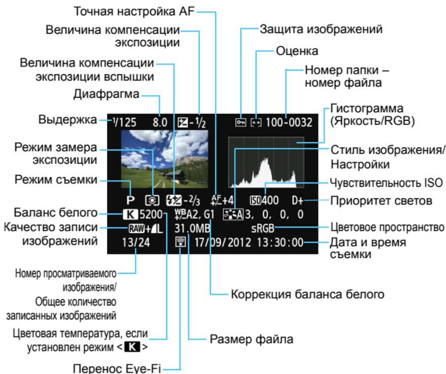
\* Если съемка производится в режиме RAW+JPEG, отображается размер файла для изображения RAW.
