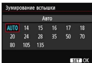
Головка вспышек Speedlite оснащена зумом, что позволяет задавать для вспышки различный угол освечивания. Обычно выбирается пункт **[AUTO]** для автоматического определения угла освечивания, соответствующего фокусному расстоянию объектива.
