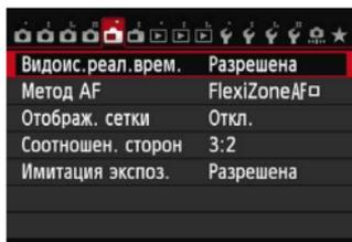
Здесь приводится описание настроек функций, специфических для съемки в режиме ЖКД-видеоискателя. Сведения об элементах меню на вкладках [📷1] и [📷2] приводятся на стр. 187-191. В режимах базовой зоны не отображаются некоторые пункты на вкладке [📷1], кроме того, не отображается вкладка [📷2].
