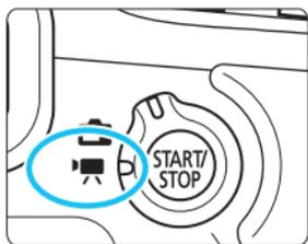
Видеосъемка включается при установке переключателя съемки в режиме ЖКД-видеоискателя/видеосъемки в положение <[camera icon]>. Используется тип видеоизображений MOV.
