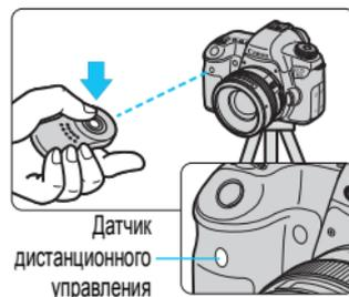
⚠ Освещение с использованием флуоресцентных ламп или светодиодов может привести к неполадкам в работе камеры, вызывая случайное срабатывание спуска затвора. Старайтесь держать камеру вдали от таких источников света.
