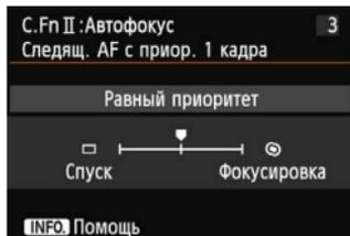
Вы можете настроить характеристики работы автофокусировки и синхронизацию срабатывания затвора для первого кадра при непрерывной съемке с помощью следящей автофокусировки AI Servo AF.
