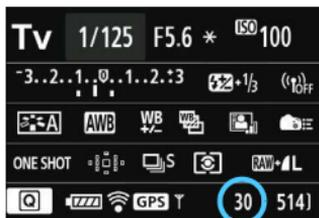
В правой нижней области видоискателя и на экране настроек функций съемки отображается соответствующая максимальная длина серии.
