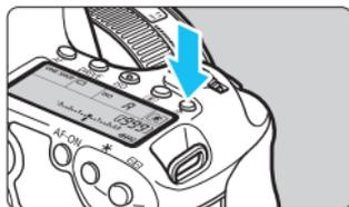
Включите (☀6)/выключите подсветку ЖК-индикатора нажатием кнопки <☀6>. В режиме ручной длительной выдержки полное нажатие кнопки спуска затвора приводит к отключению подсветки ЖК-индикатора.
