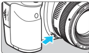
Нажав кнопку предварительного просмотра глубины резкости, можно привести диафрагму объектива в соответствие с текущей установкой и проверить глубину резкости.
