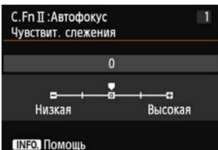
Установка чувствительности для отслеживания фокусировки объектов в режиме AI Servo AF (следающая автофокусировка) при появлении препятствия в точках автофокусировки или в том случае, если точки автофокусировки отклоняются от объекта.
