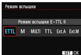
**[Режим вспышки E-TTL II]** – это стандартный режим вспышек Speedlite серии EX для автоматической съемки со вспышкой.
