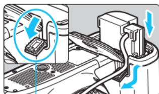
Отверстие для кабеля переходника постоянного тока
