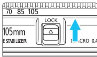
Можно предотвратить выдвигание объектива во время его переноски. Установите кольцо зумирования в широкоугольное положение 24 мм, затем передвиньте рычаг фиксатора кольца зумирования в положение <LOCK>. Кольцо зумирования можно зафиксировать только в широкоугольном положении.
