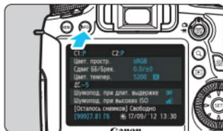
Когда камера готова к съемке, нажав кнопку <INFO.>, можно отобразить параметры [Отображ. настройки фотоапп.], [Электронный уровень] (стр. 60), и [Отображ. функций съемки] (стр. 333).
