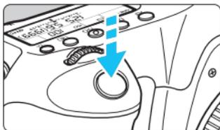
Во время видеосъемки можно сделать снимок, полностью нажав кнопку спуска затвора.
