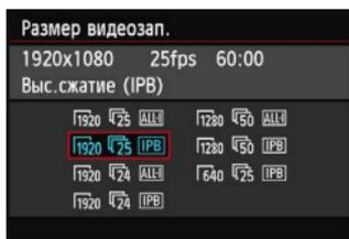
С помощью параметра [ **2: Размер видеозап.** ] можно задать размер видеоизображения, скорость видеозаписи и метод сжатия данных. Скорость видеозаписи переключается автоматически в зависимости от настройки [ **3: ТВ-стандарт** ].
