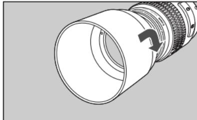
Бленда ET-67 не допускает нежелательные блики и свет на линзы объектива, а также защищает объектив от попадания на поверхность линзы дождя, снега и пыли. Подсоедините и выровняйте бленду на креплении бленды в передней части объектива, затем поверните бленду, как это указано стрелкой, чтобы надежно закрепить ее. При хранении объектива можно закрепить бленду на объективе в обратной ориентации.
