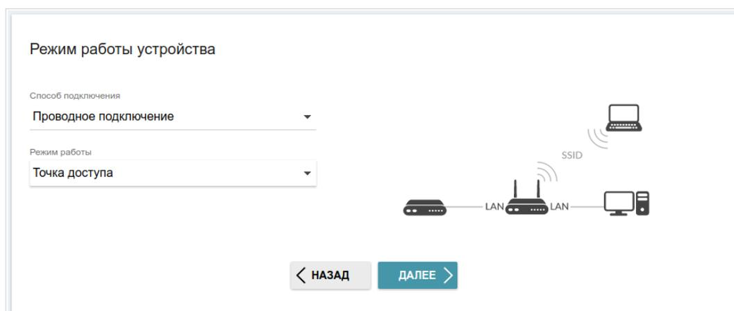
Рисунок 37. Выбор режима работы устройства. Режим **Точка доступа**.
