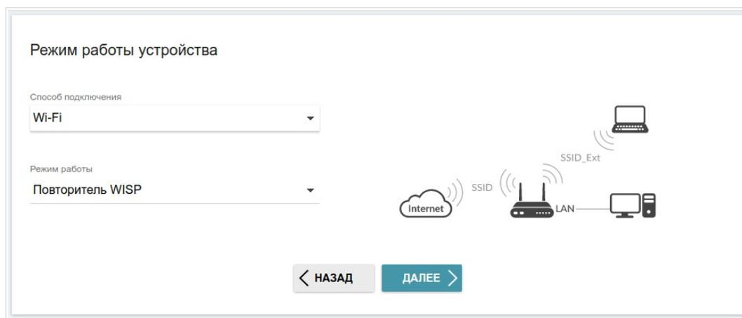
Рисунок 36. Выбор режима работы устройства. Режим **Повторитель WISP**.
