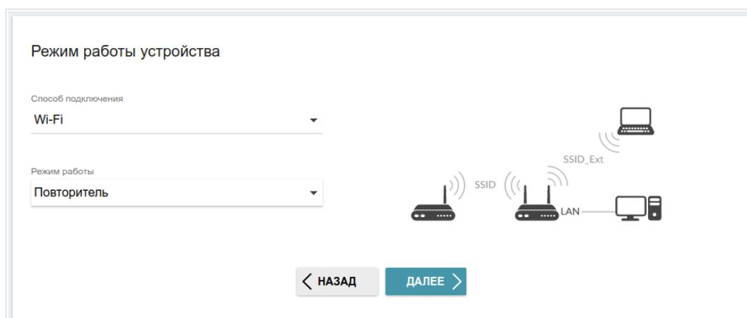
Рисунок 38. Выбор режима работы устройства. Режим **Повторитель**.
