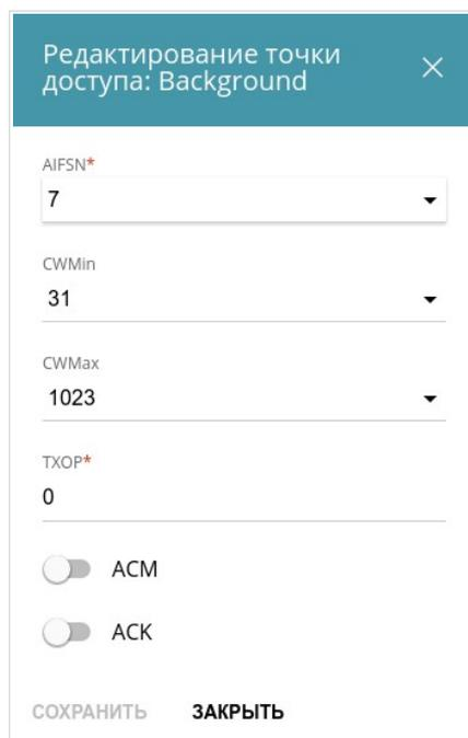
Рисунок 100. Окно для изменения параметров функции WMM.
