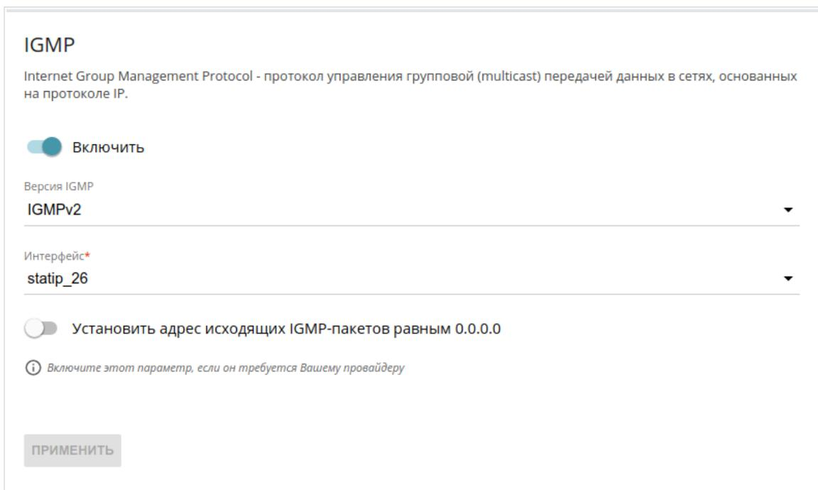
Рисунок 122. Страница **Функции / Дополнительно / IGMP**.
